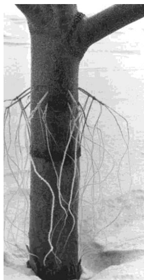
Рис. 2. Измерение температуры тканей плодовых деревьев: а - МТ-57 с прижимным устройством в натуральную величину; б - установка МТ-57 на дереве яблони; во время фотосъемки был иней, поэтому отчетливо видны тонкие подводящие провода
